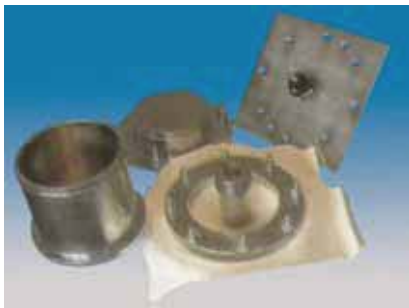
不織布細孔試験用ツール (ISO, UNI準拠) Code 2510.690
